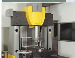
德国ZEISS三坐标测量仪
